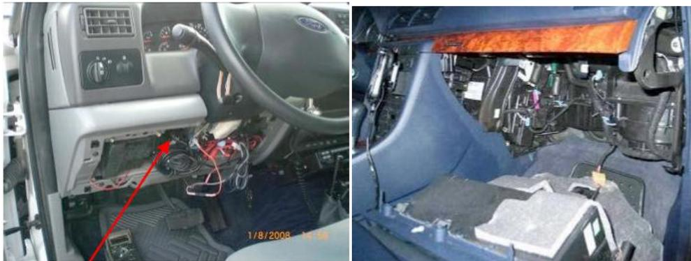
**Note:** Les antennes cellulaires et GPS sont intégrées au boîtier. Lorsque installé, sous le tableau de bord ou derrière la boîte à gants, déplacer le modem vers le haut près de la fenêtre. Solidifier avec des attaches (tie wraps). Assurez-vous qu'aucune pièce de métal n'entravera le signal cellulaire ou GPS. Le plastique n'interfère pas.
